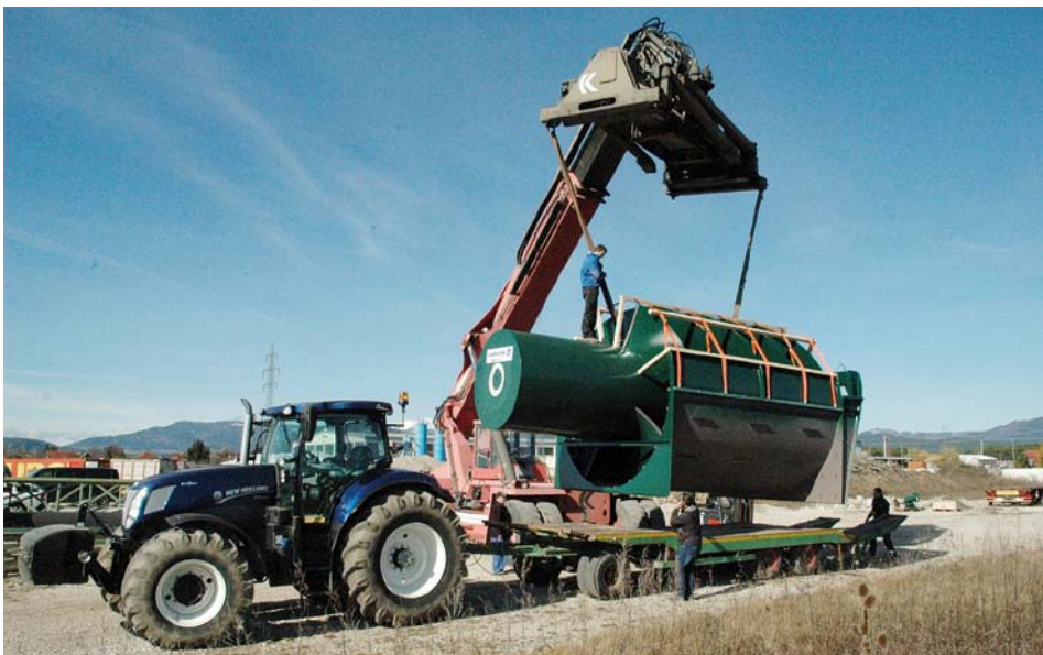
Abb. 7: Die Wasserkraftschnecke wird mittels Containerstapler auf ein Traktorgespann umgeladen.
