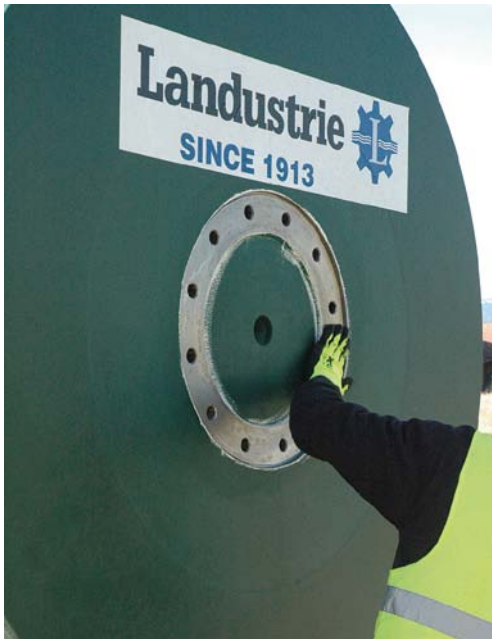
Abb. 1: Oberes Schneckenende mit Anschluss Richtung Lager
