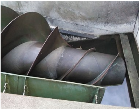
Abb. 1: „Verstümmelung“ der Wasserkraftschnecke als vermeintliche Hilfsmaßnahme im Jahr 2015, Aufnahme bei Niederrwasser
